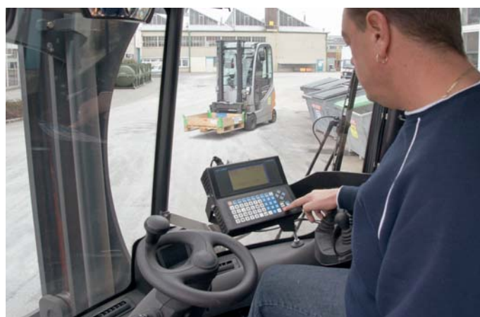
Optimiert: Der Staplerfahrer erhält vom Leitsystem den nächsten Transportauftrag
